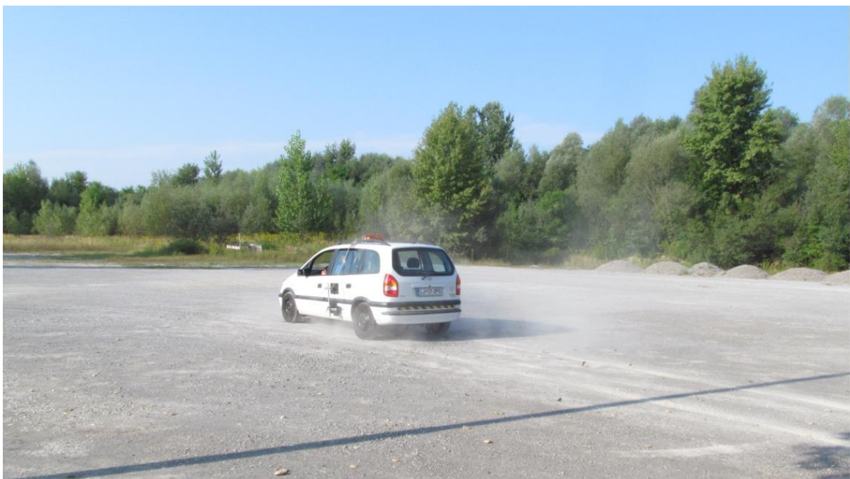
Slika 7: Izvedba zavornega preizkusa na makadamski podlagi
