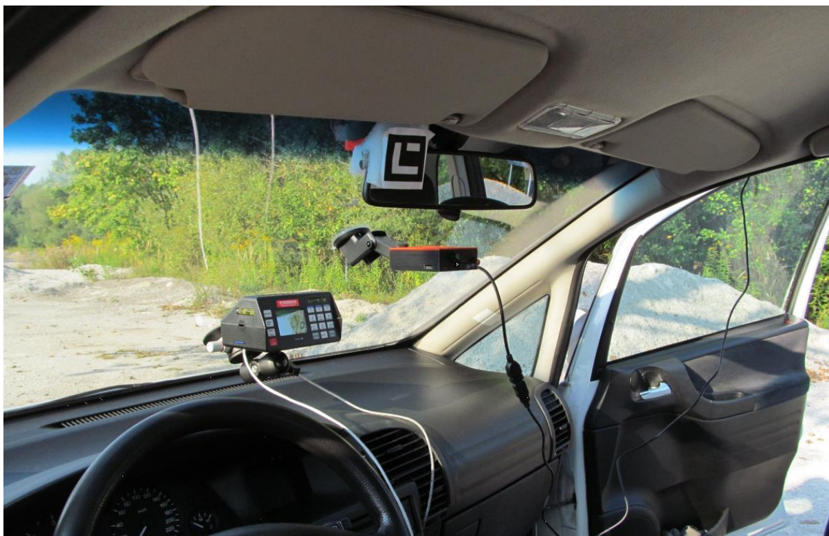
Slika 4: Namestitev prototipa naprave CONSKID v osebno vozilo skupaj s kalibrirano merilno napravo Vericom VC4000DAQ
