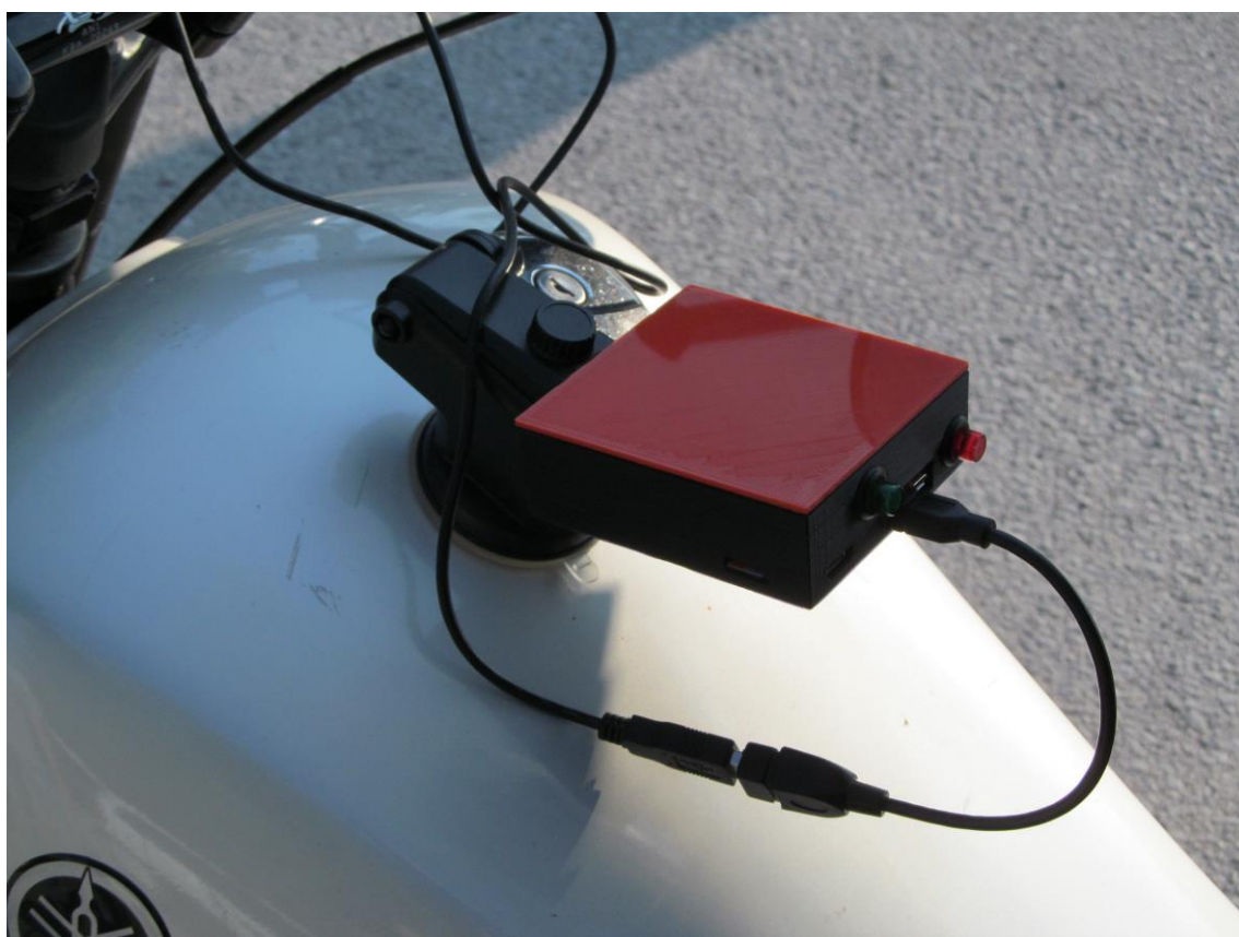
Slika 5: Namestitev prototipa naprave CONSKID na motorno kolo
