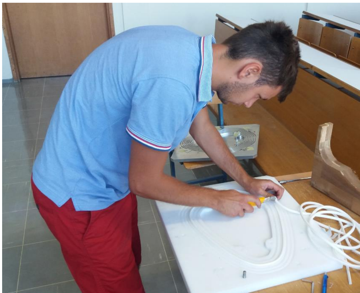
Slika 4: Vstavljanje tesnila pri funkcijskem prototipu za izbor naustrežnejšega tesnila na Fakulteti za strojništvo v Ljubljani.
