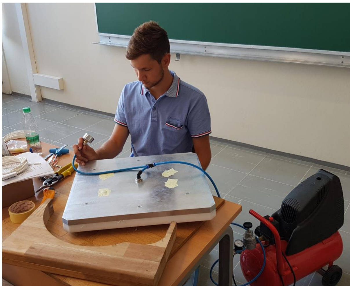
Slika 5: Izvajanje meritve padca tlaka pri funkcijskem prototipu za izbor naustrežnejšega tesnila na Fakulteti za strojništvo v Ljubljani.
