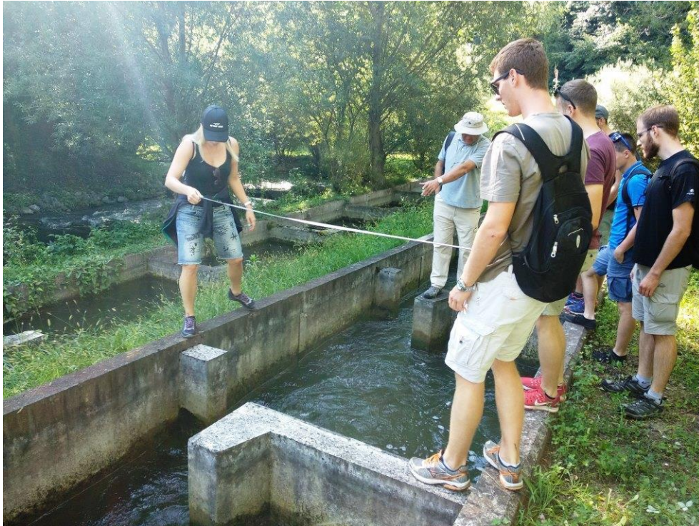
Izvedba terenskih izmer na ribji stezi HE Blanca
