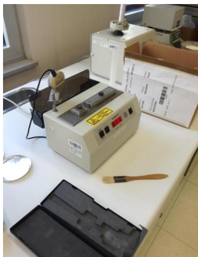
Testni napravi za določanje trdnosti in razpadnosti tablet
