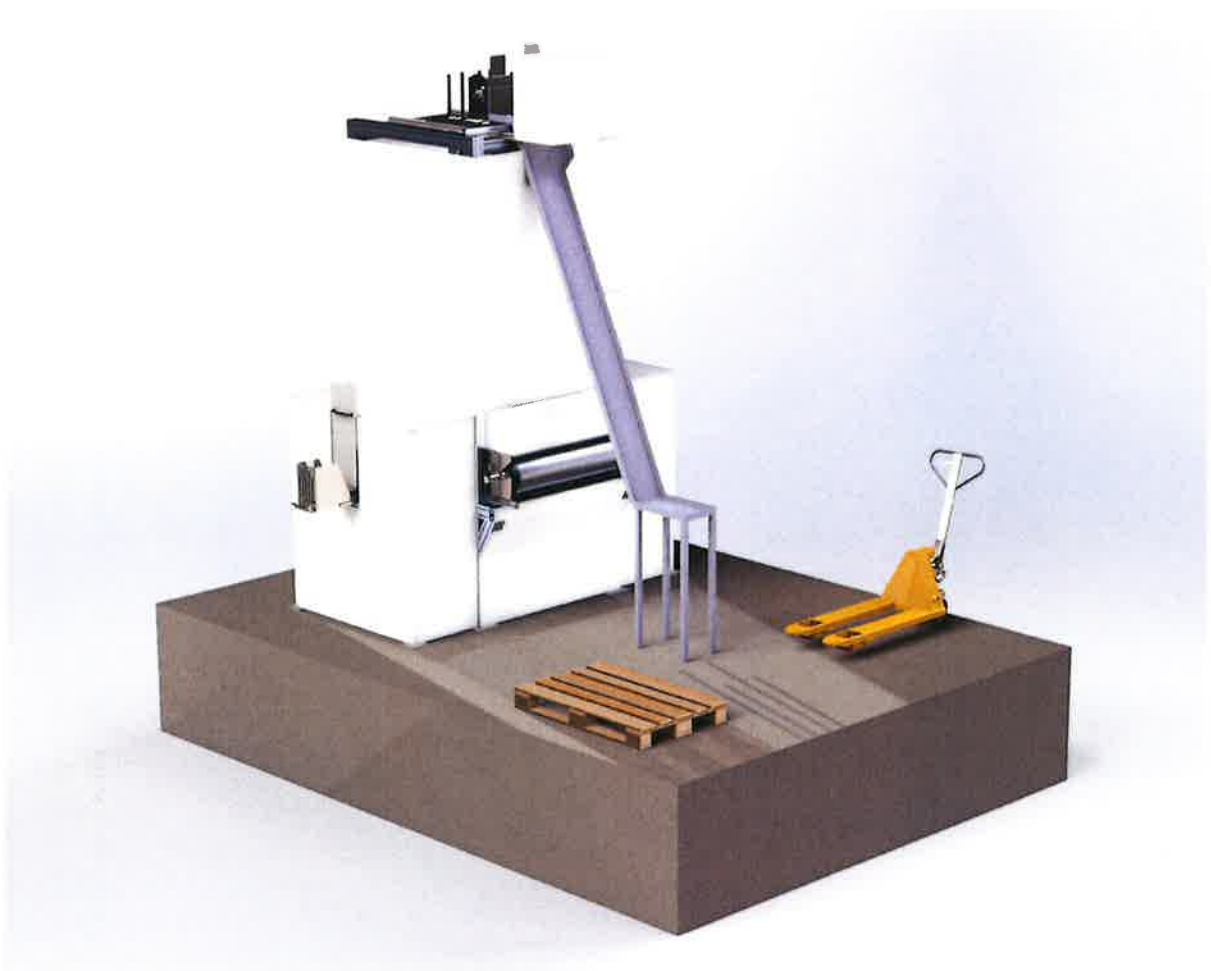
Slika 1: Izgled naprave za samodejno pakiranje papirnatih vrečk
