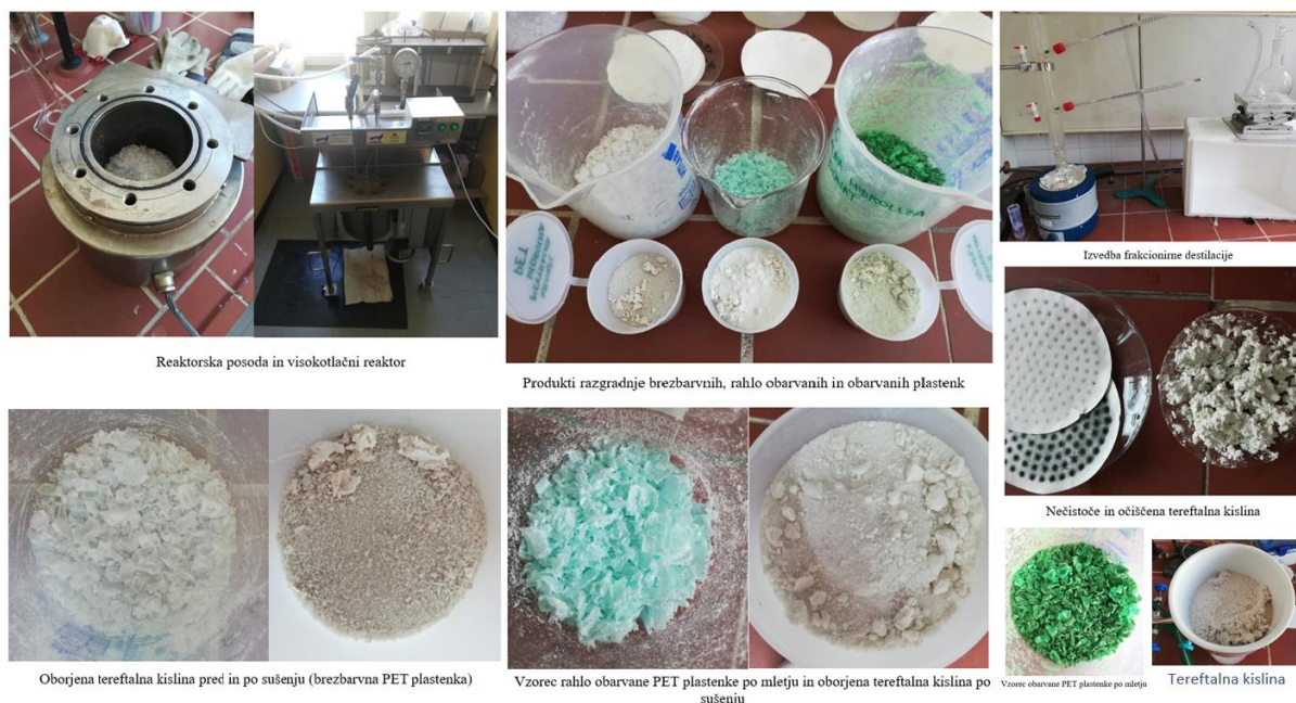
Slika 1: Laboratorijska pretvorba PET plastike do tereftalne kisline in etilen glikola
